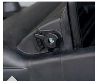
Einfache und werkzeuglose Höhenverstellung der Kehrwalze
