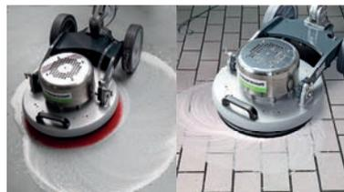
▶ Grundreinigung mit Wasser von Hart- und Vinylböden
