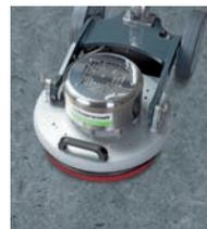
▶ Entwachsen und Aufpolieren von Vinylböden
