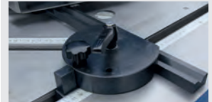
► Exakte Winkeleinstellung mithilfe von Anschlägen und Skalen
