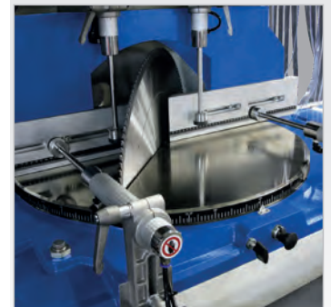
► Stufenlose Verstellung des Gehrungswinkels
