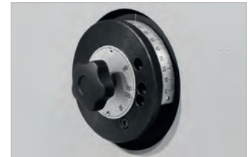
· serienmäßige Steuerung MA – manuelle Verstellung des Biegewinkels mittels Skalenring an der linken Maschinenseite
