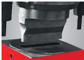
► Optionale Stanzeinrichtung für große Durchmesser
