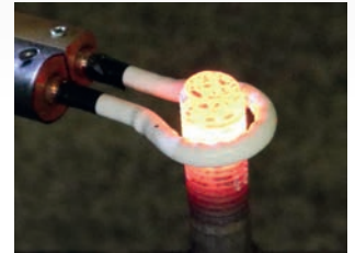
› Erwärmen eines Gewindebolzens mit der wassergekühlten Spule
