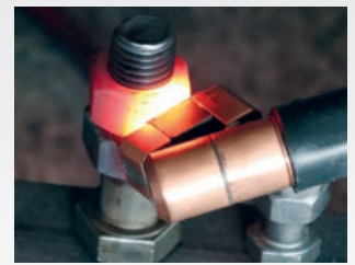
› Erwärmen einer Mutter mit der Fokusspule schräg
