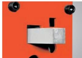
▶ Profilstahlschere / Vierkantstahlmesser
