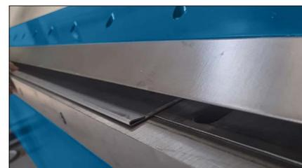
Falzleistung bis 2mm auf einer Arbeitsbreite von 3.200 mm
