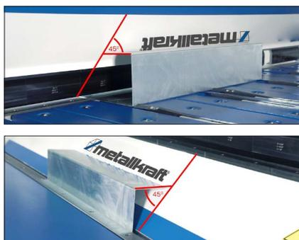
Die 45° Geometrie an beiden Seiten der drehbaren Oberwange ermöglicht die höchst flexible und einfache Herstellung von schmalen Teilen
