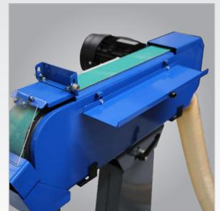
Planschleiftisch mit Schleifband
