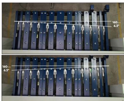
Schräg verstellbarer servomotorischer Hinteranschlag ermöglicht die Erweiterung des Produktspektrums (Option)
