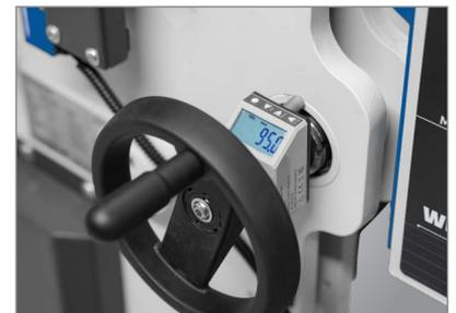
Verstellung des Hinteranschlags über Handrad mit Zählwerk
