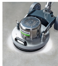
▶ Aufarbeiten und Schleifen von Estrichböden
