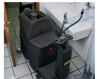
Frischwassertank mit Schlauch für Schnellbefüllung
