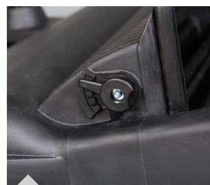
Einfache und werkzeuglose Höhenverstellung der Kehrwalze
