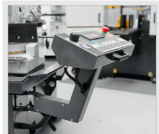
Schwenkbares Bedienpult ▶ Erleichtert das Arbeiten auch bei Schnitten auf Anriss
