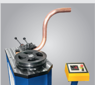
▶ Biegewinkel bis 180° möglich
