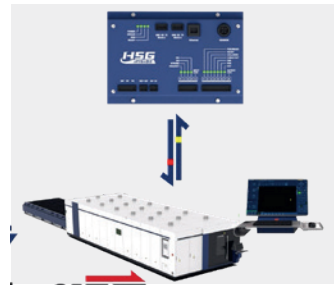
HSG Bus-basiertes Steuerungssystem
