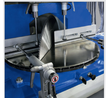
▶ Stufenlose Verstellung des Gehrungswinkels
