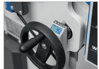
Verstellung des Hinteranschlags über Handrad mit Zählwerk
