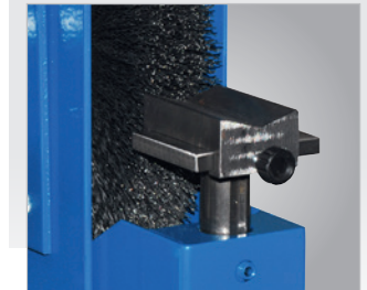
▶ Mit verstellbarer Prismen Werkstückauflage
