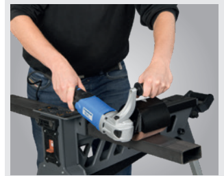
▶ Satinieren von flachem Material
