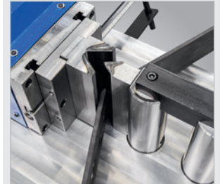
▶ Mit Schnellwechsellafnahme und Seitenanschlag mit Skala
