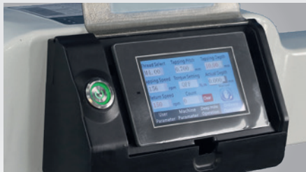
▶ Einstellung der Parameter über im Schwenkarm integrierten Touchscreen
