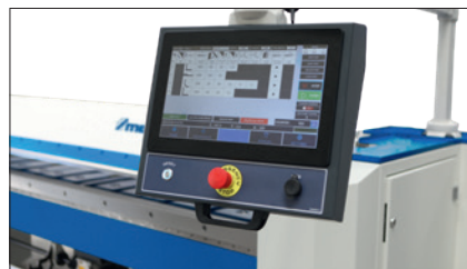
Bedienerfreundliche 15,6" Touchscreen NC-Steuerung an ergonomischen Schwenkarm
