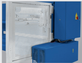
▶ Rückraumsicherung nach CE mit Seitenblechen und Lichtschanke
