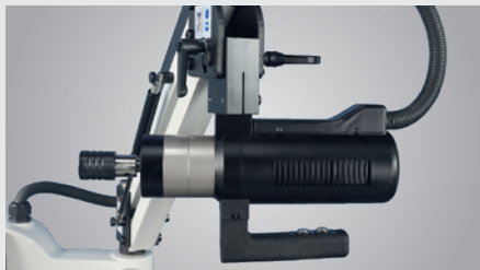
▶ Maschinenkopf von 0 bis 90 Grad schwenkbar
