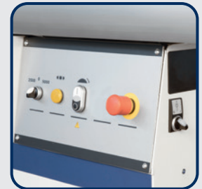
▶ Mit manueller Höhenverstellung und Schwenkung des Sägeaggregats per Handrad ▶ Zwei Schnittgeschwindigkeiten über Inverter schaltbar ▶ Zuschaltung der Mikroprüheinrichtung
