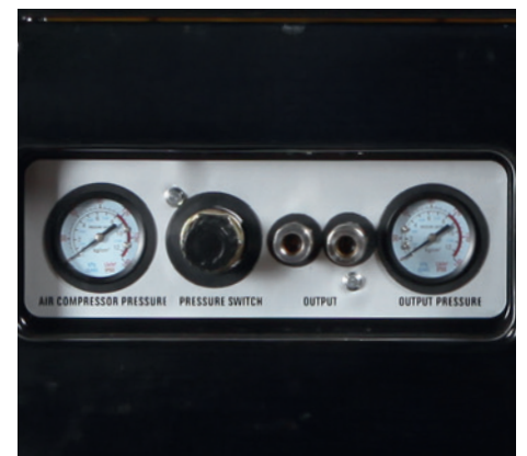
› Zwei Einhand-Schnellkupplungen für das Betreiben von Druckluftwerkzeug
